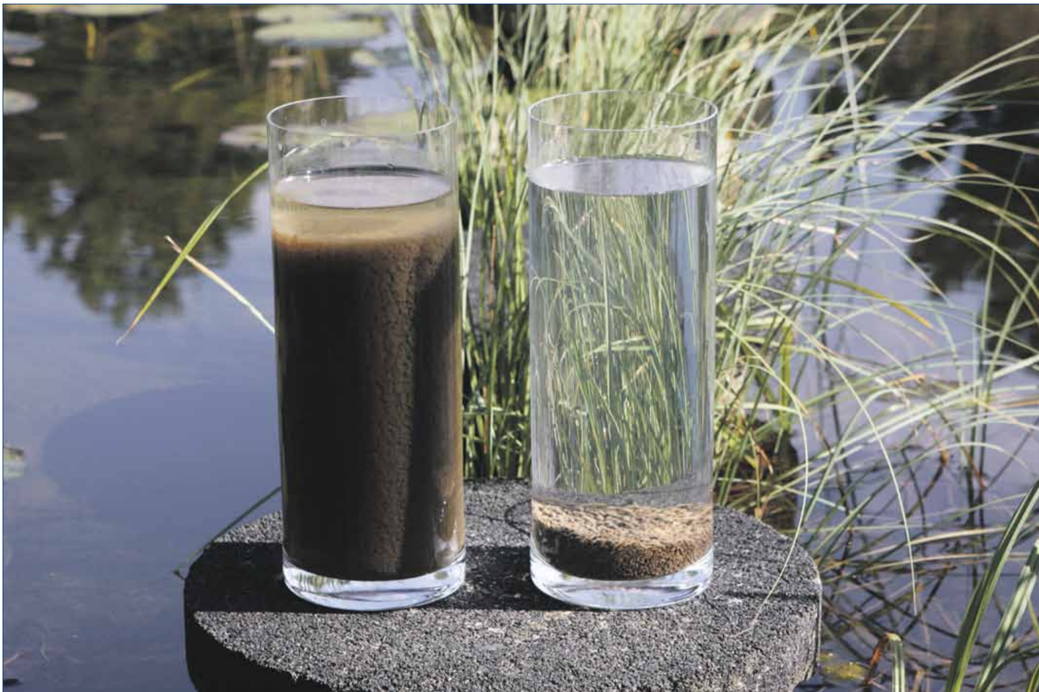
Korrels bezinken veel vlugger, waardoor het zuiveringsproces sneller verloopt.
