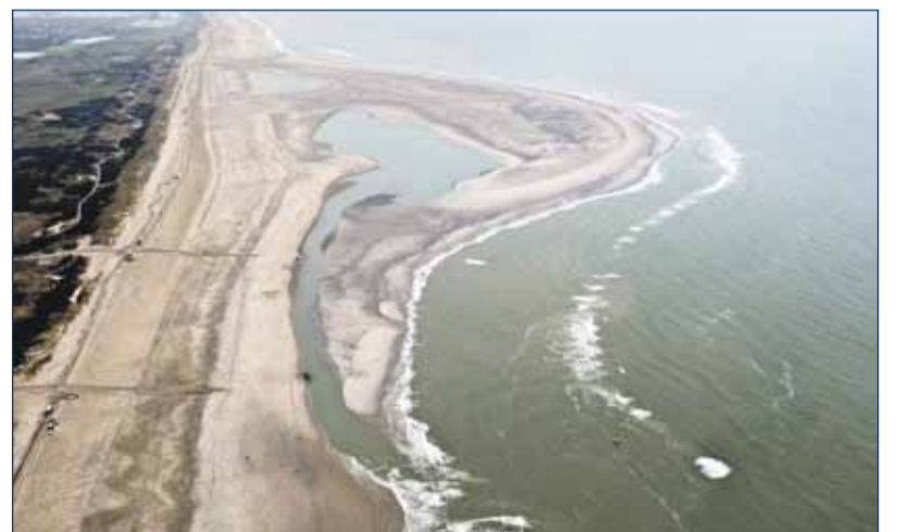
Had de kersverse suppletie in augustus 2011 nog de vorm van een bolle haak, in de lente van 2012 is het schiereiland uitgerek, noordwaarts langs de kust. De zandmotor komt op gang. Foto's: Rijkswaterstaat/Joop van Houdt.
