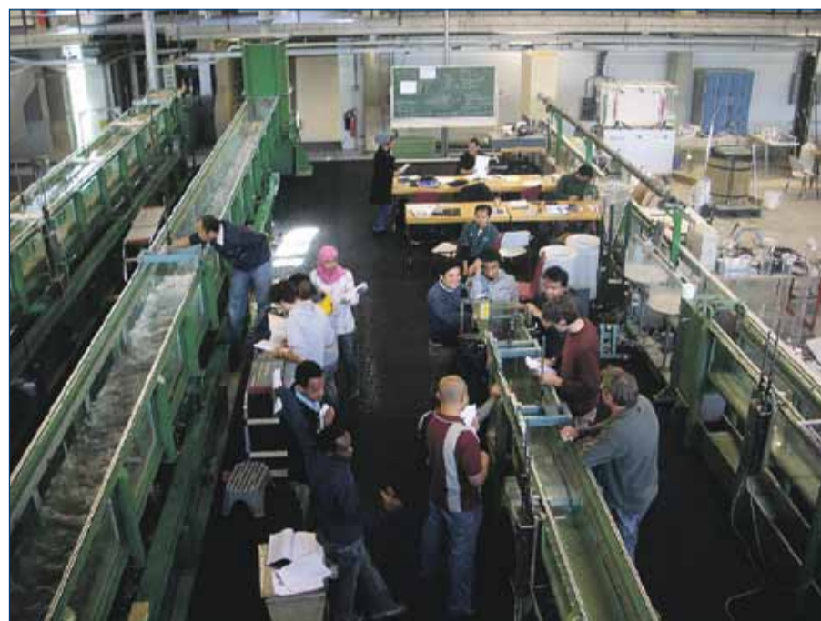
In het Laboratorium voor Vloeistofmechanica houden onderzoekers zich vooral bezig met de waterbeweging in natuurlijke en kunstmatige watersystemen. Onderwerpen van onderzoek zijn bijvoorbeeld oppervlaktegolven, de wisselwerking met constructies en slibtransport. Het laboratorium beschikt over uitgebreide computerfaciliteiten. Foto: TU Delft.
