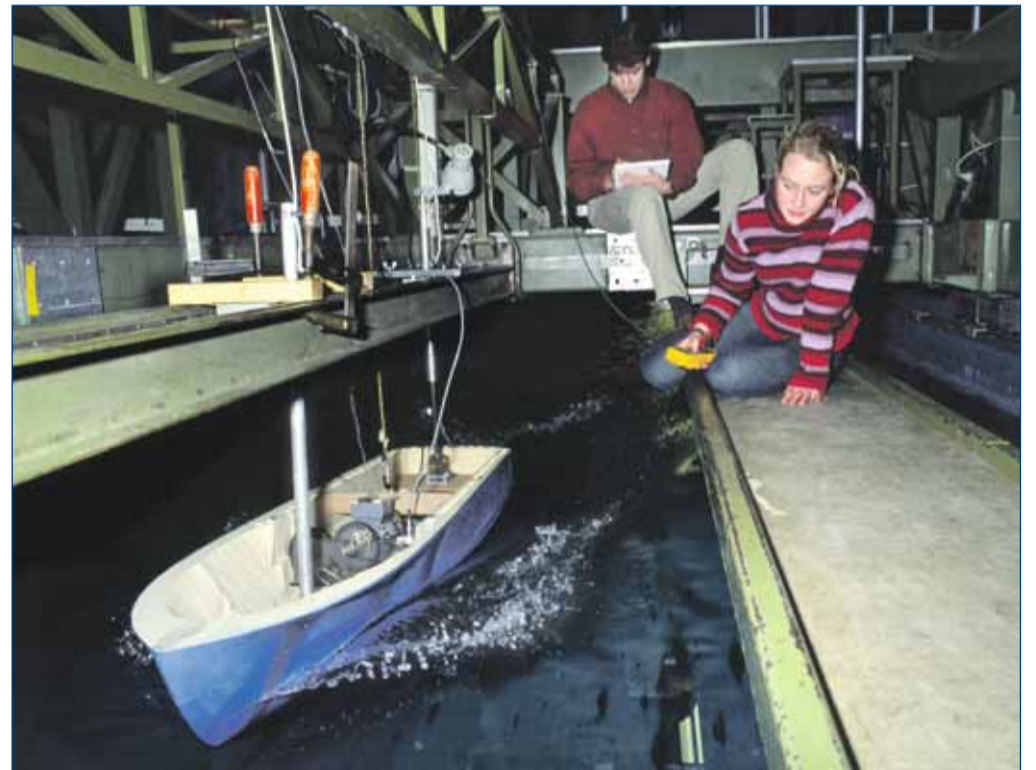
Studenten doen metingen in de sleeptank. De weerstand van water, stromingen en golven hebben invloed op het vaargedrag van schepen. Om dit soort invloeden te testen beschikt de TU Delft over een sleeptank met een lengte van 142 meter, een breedte van ruim 4 m en een diepte van 2,5 m. Met behulp van beweegbare schotten kunnen golfbewegingen worden nagebootst en met ventilatoren wordt de wind nagebootst. Foto: TU Delft.
